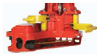
Unité de marquage dans le caisson de scie
