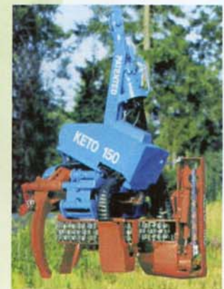
5 - Tête de façonnage Keto 51 entrainement par deux chenilles tracks.
